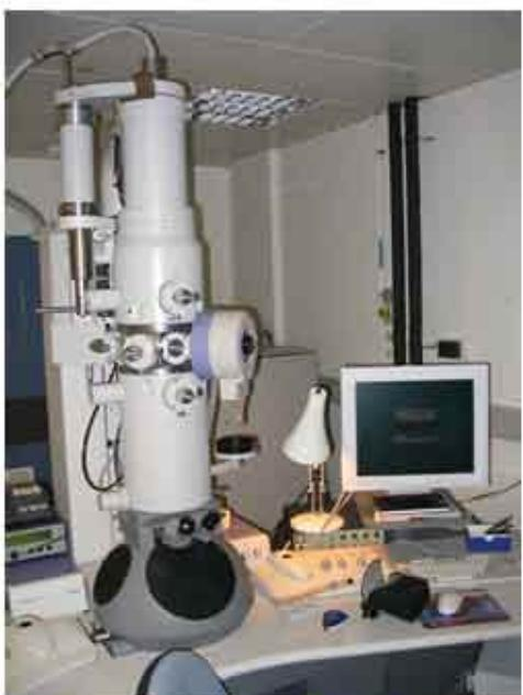
চিত্র 2.28: ইলেক্ট্রন অপুরীক্ষণ যন্ত্র
