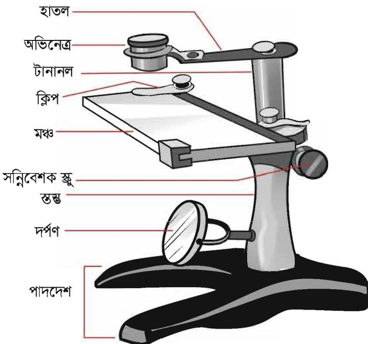
চিত্র 2.26: একটি সরল অণুবীক্ষণ যন্ত্র।
